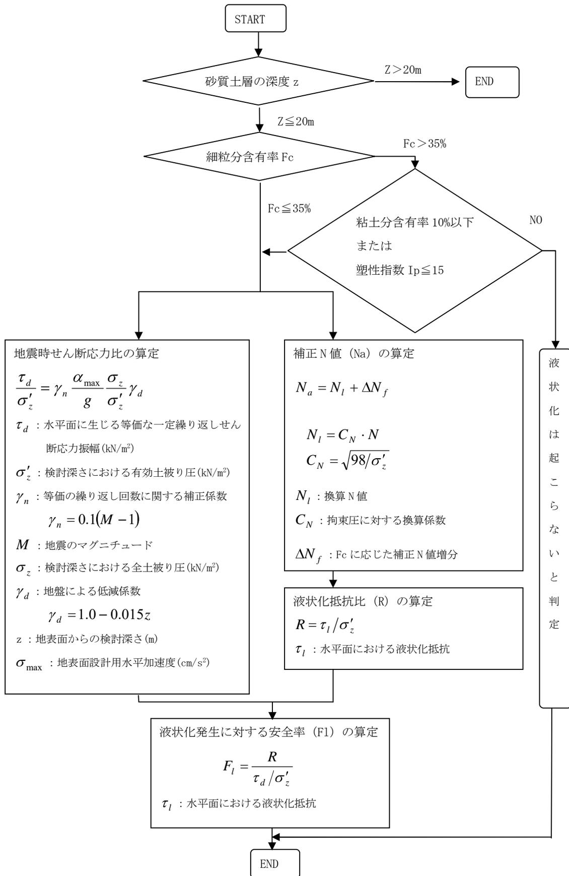
建築基礎構造設計指針による液状化判定フロー
